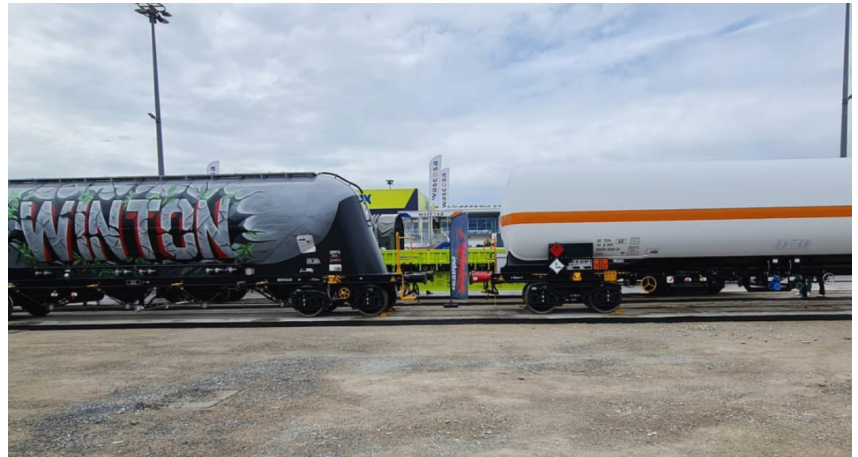
Şekil 1: Winton Industries Firması'nın ürettiği Türkiye'nin ilk 117m3 ZAGS Tipi LPG ve 82m3 UACNS Tipi Toz Vagonları (Kaynak: Yazarın Kendi Çekimi).
